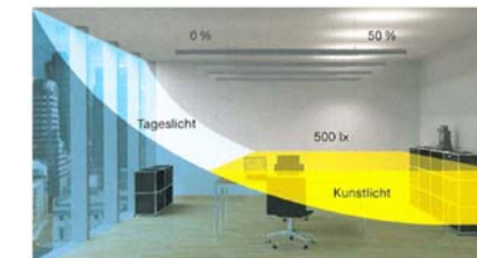
Allg. Strom, Tageslichtabhängige LED Beleuchtung
